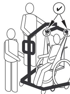
Levez la flèche jusqu'à ce qu'il y ait une tension sur les bandes de la sangle et assurez-vous que la sangle est correctement fixée aux crochets du fléau. Reportez-vous à la section 6.2.1 Installation de la sangle sur le lève-personne, page 19. Si l'une des attaches n'est pas correctement installée, redescendez le patient sur le fauteuil roulant et corrigez le problème.
