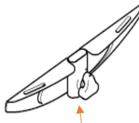
A glisser entre l'appui-tête et la fixation d'appui-tête
