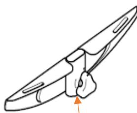
A glisser entre l'appui-tête et la fixation d'appui-tête
