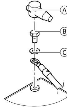
Fig. 6-56 La borne positive sert d'exemple.
