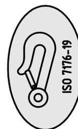
Utilisez les sangles avant et arrière du système de retenue pour fauteuil roulant à 4 points pour fixer le fauteuil roulant sur les rails du véhicule. Consultez le manuel d'utilisation fourni avec le système de retenue pour fauteuil roulant à 4 points.
