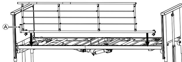
Placez la barrière au-dessus du cadre avec le système de déverrouillage **A** côté tête du lit.
