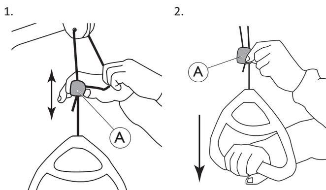
1. Tirez le cordon sur le côté et faites glisser le système de blocage Ⓐ vers le haut ou vers le bas jusqu'à ce que la poignée se trouve à la hauteur souhaitée.
