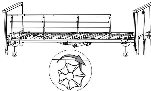
Serrez les vis à molette **B** pour fixer la barrière au cadre. Assurez-vous qu'elle est stable et correctement serrée.
