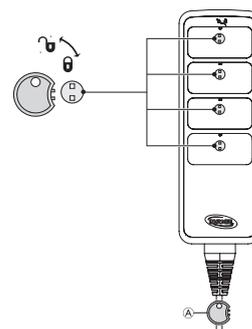
1. Insérez la clé (A) dans le trou situé juste au-dessus de la fonction souhaitée.
