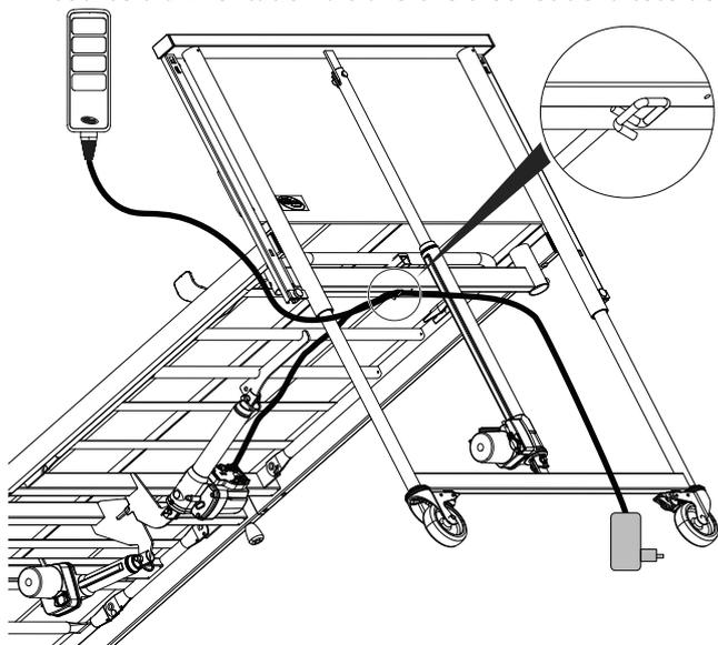
11. Placez l'extrémité de la partie enroulée du câble du moteur de montée/descente sur le crochet du pied de lit.
