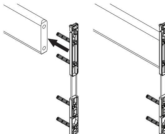
À l'autre extrémité du barreau de la barrière, poussez les deux cliquets supérieurs contre l'extrémité du barreau.
