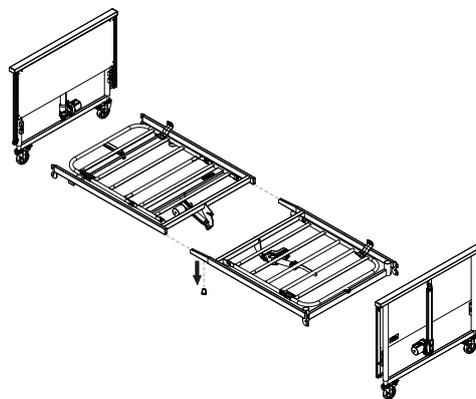
2. Poussez les tiges de la partie tête du plan de couchage dans les tubes latéraux de la partie pieds du plan de couchage.
