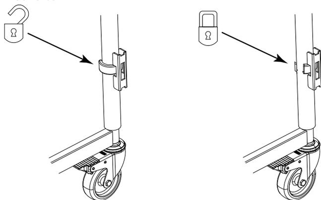
6. Verrouillez les supports du plan de couchage au niveau du panneau et appuyez fermement pour les enclencher.
