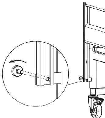
Resserrez la vis au-dessous du barreau inférieur de la barrière, au coin de chacune des extrémités du lit.
