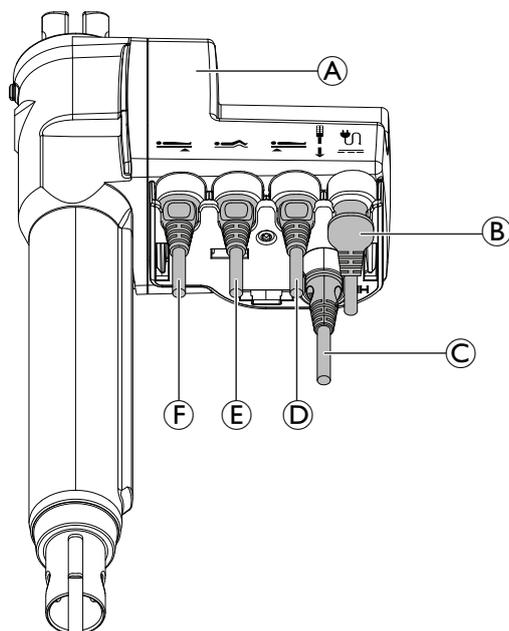
Le vérin avec l'unité centrale intégrée **A** comporte une étiquette sur laquelle figurent les symboles indiquant l'emplacement où il faut brancher les fiches des moteurs :
