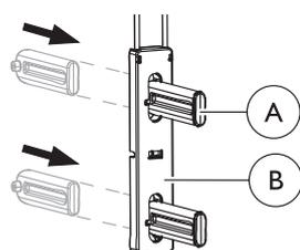
En partant de l'arrière, introduisez le cliquet ① dans le coulisseau ② jusqu'à ce que le déclic de verrouillage se fasse entendre.
