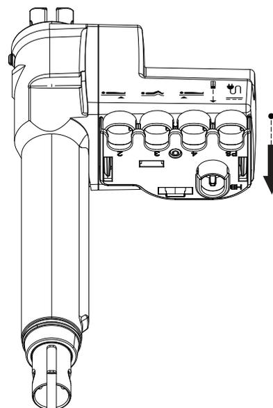
2. Levez manuellement le relève-buste et branchez les câbles desserrés du moteur de montée/descente sur l'unité centrale.
