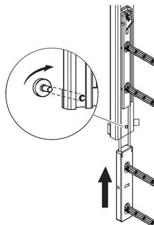
Desserrez la vis dans la partie inférieure des guides sur l'un des panneaux du lit et poussez le coulisseau à mi-course dans le guide jusqu'à ce qu'il s'enclenche avec un clic audible.
