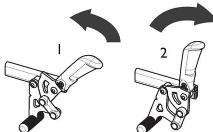
1. Pour enclencher le frein, tirez le levier de frein vers l'arrière avec les doigts, aussi loin que possible.
