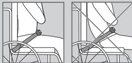
**Fermeture et ouverture de la ceinture de maintien**
