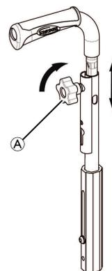
1. Pour régler la hauteur des poignées de poussée, desserrez la molette (A), poussez la poignée jusqu'à la position souhaitée et resserrez la molette.
