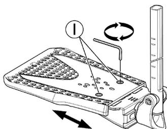
1. Desserrez les deux vis de fixation I à l'aide d'une clé Allen de 5 mm.
