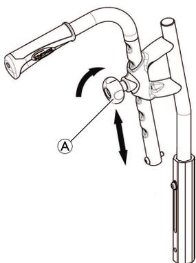
1. Pour régler la hauteur des poignées de poussée, desserrez la molette (A), poussez la poignée jusqu'à la position souhaitée et resserrez la molette.
