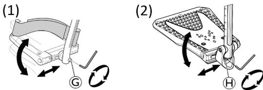
1. Desserrez la vis de fixation G ou H à l'aide d'une clé Allen de 5 mm.
