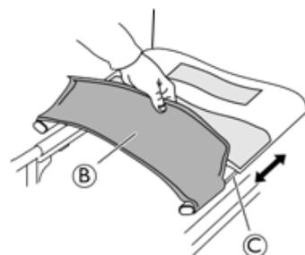
3. Réglez la profondeur en tirant les côtés de l'assise vers l'avant ou vers l'arrière dans les rails des tubes latéraux (C). Veillez à ce que les deux côtés soient ajustés uniformément.
