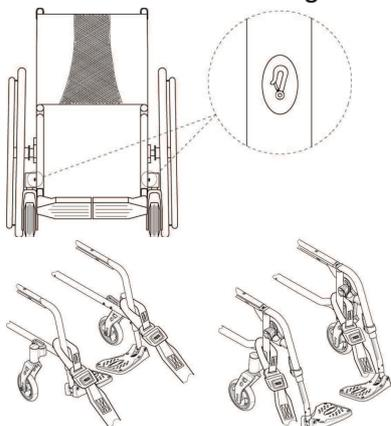
1. Fixez les sangles avant au-dessus des supports de roulettes avant, comme indiqué sur la figure ci-dessus (cf. emplacement des étiquettes de fixation).
