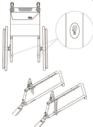
1. Fixez les mousquetons sur le châssis arrière, juste au-dessus de la platine porte-axe, comme indiqué sur les deux figures ci-dessus (cf. emplacement des étiquettes de fixation).
