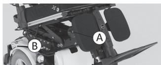
Le capteur G-Trac en option est installé derrière le carter arrière.
