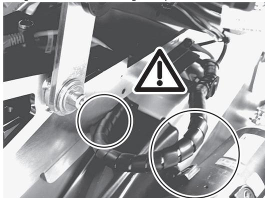
3. Levez et baissez plusieurs fois l'assise en observant attentivement le faisceau de câbles. Le faisceau de câbles ne doit pas être coincé, étiré ni écrasé. Le faisceau de câbles doit se déplacer sur les côtés, comme indiqué sur les illustrations qui suivent. Le moteur d'entraînement ne doit pas être en contact avec le faisceau de câbles.
