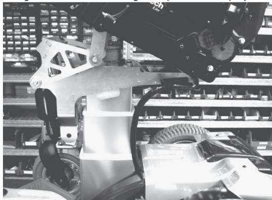
Fig. 11-8 Colonne de levage complètement rétractée
