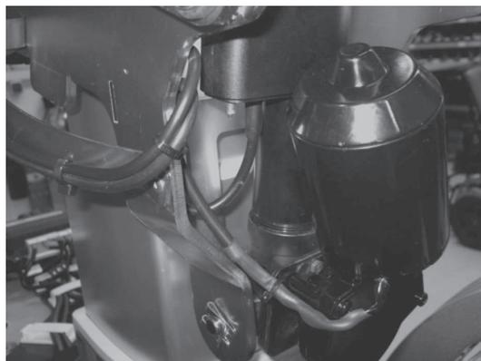
1. Acheminez les câbles entre le vérin (2) d'inclinaison du siège et le support de câble (1).
