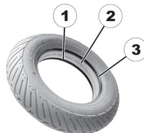
2. Poussez le pneu avec revêtement increvable sur le moteur (carter du rotor).
