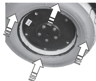
3. Positionnez la moitié de jante dans le pneu. Les trous des vis de la moitié de jante doivent être alignés sur ceux du carter du rotor. Il peut être utile d'aligner l'encoche présente sur la moitié de jante sur une encoche logeant habituellement la valve dans le carter du rotor, puis de les utiliser comme guide de positionnement.
