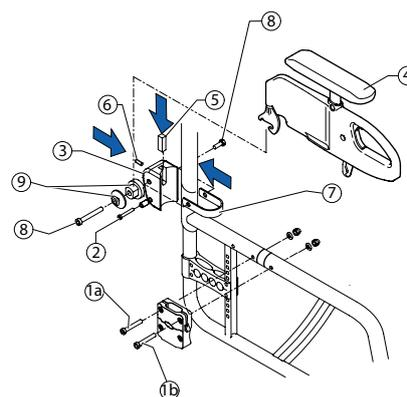
**i** Les manchons ⑨ diffèrent pour l'accoudoir escamotable vers l'arrière dans le coloris du châssis et pour l'accoudoir escamotable vers l'arrière avec mécanisme d'enclenchement.
