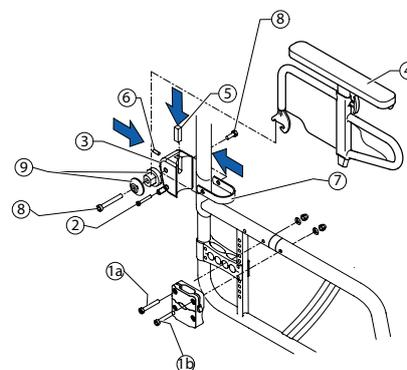
**i** Les manchons ⑨ diffèrent pour l'accoudoir escamotable vers l'arrière dans le coloris du châssis et pour l'accoudoir escamotable vers l'arrière avec mécanisme d'enclenchement.
