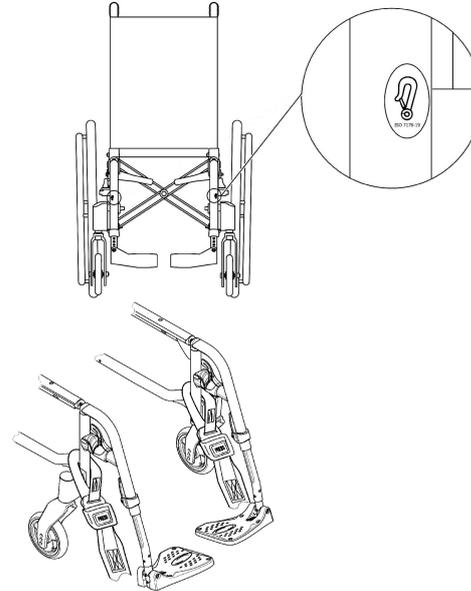
1. Fixez les sangles avant au-dessus des supports de roulettes avant, comme indiqué sur la figure ci-dessus (cf. emplacement des étiquettes de fixation).
