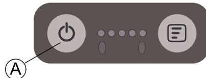
Le bouton d'alimentation **A** se trouve sur le côté gauche du manipulateur. Il intègre un témoin d'état qui change de couleur en fonction de l'état du système :
