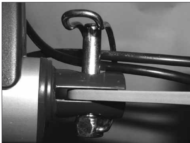
Câblage des moteurs du relève-jambes et du panneau de lit (pied) via la goupille du moteur de relève-buste.
