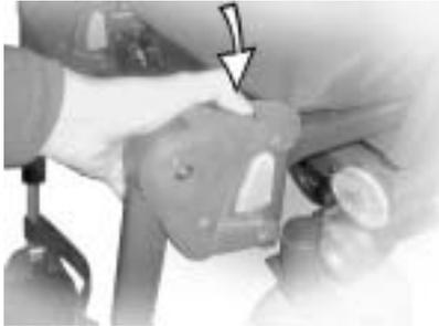
Déverrouiller le repose-pied en appuyant sur le bouton.
