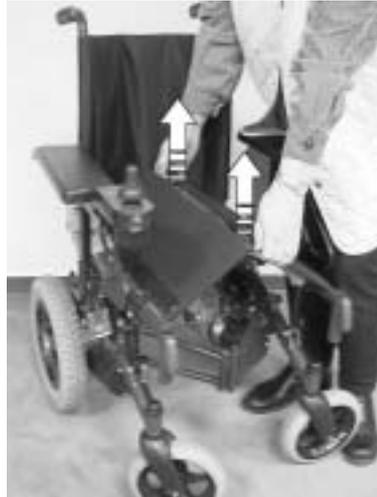
Pencher légèrement le fauteuil roulant sur le côté. Soulever les bords avant et arrière de la plaque de siège.
