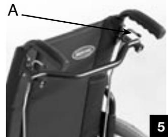
Pour ne pas déstabiliser la position de l'utilisateur, évitez d'actionner les leviers (A) lors d'un transfert latéral, par exemple !
