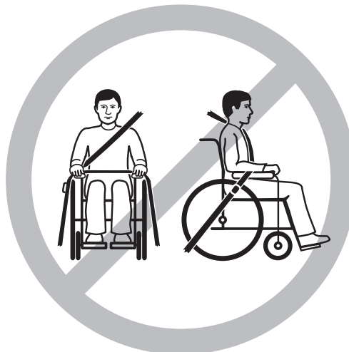
Position incorrecte de la ceinture
