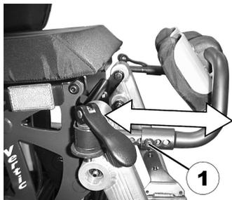
L'espacement des trous est différent dans les tubes intérieur et extérieur. Les différentes combinaisons des trous permettent un réglage précis de la fixation.
