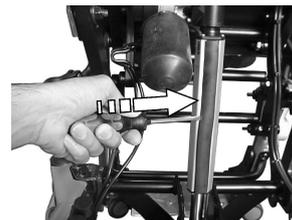
Repositionnez le cache en caoutchouc et insérez-le délicatement dans la fente.
