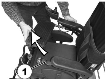
Desserrez la fixation à déverrouillage rapide (1).
