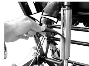
Détachez doucement le cache en caoutchouc à l'extrémité supérieure de l'unité centrale et retirez-le.
