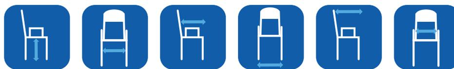
Hauteur d'assise ▼    Largeur d'assise ▼    Profondeur d'assise ▼    Largeur hors-tout ▼    Profondeur hors-tout ▼    Largeur entre les accoudoirs ▼
