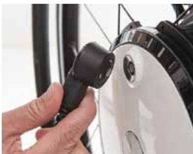
Le connecteur de charge est situé sur la roue...
