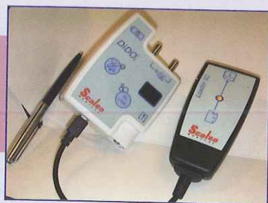
Fig. 7 – Dispositif médical permettant le monitoring de l'observance de l'OLD (débit d'O 2 et temps de déambulation)
